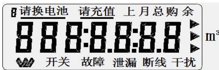
**0**: 分表号, 从 0 到 1。未显示时表示表计处于厂内状态, 显示“0”时表示表计处于出厂状态, 可以接收合法的用户卡进行开户, 并在开户时将表号设入表内, 绑定用户和表计, 显示“1”时表示表计已经开户;
